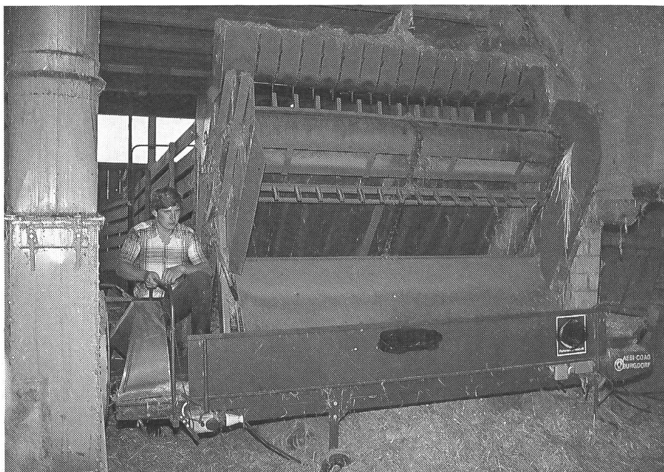
Ein Zwischenstück zwischen Zubringerband und Gebläse verhindert das Wegschleudern von Steinen.
