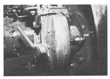
Geschwindigkeitserfassung mit Sensor und 4 Magneten am Hinterrad.
