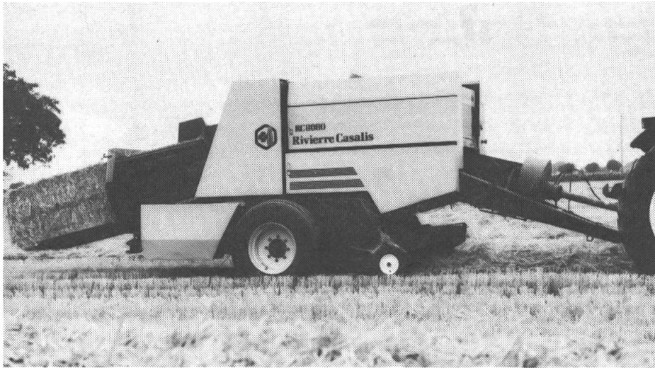
Quaderförmige Grossballen stellen inbezug auf Transport und Lagerraumausnutzung die optimale Ballenform dar. Die Beschickung des Presskanals erfolgt von unten.
