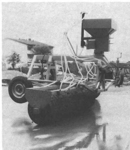
Auf die Crosskillwalze aufgesattelte Grassämaschine in Arbeitsstellung.
