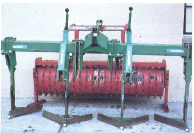
*Als Pflugsatz arbeitet die Pendelspatenmaschine schonungsvoll, indem sie eine grobschollige Bodenstruktur ohne Verdichtungshorizonte an der Bearbeitungsgrenze hinterlässt. Ihr Einsatz ist vor allem auf schweren und «nassen», von Radspuren zerfurchten Böden nach späterräumenden Kulturen (zum Beispiel Zuckerrüben) zu empfehlen.*
