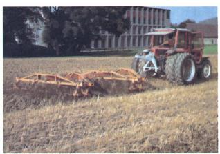
Mit einer Spatenrollegge schwerer Bauweise, bestehend aus vier hintereinander angeordneten Spatenschwellen, kann auch auf schwer zu bearbeitendem Boden eine intensive Krümel- und Mischwirkung in einem Arbeitsgang erzielt werden. Nebst der Stoppelbearbeitung ist ein bodenschonender Einsatz zur Saatbettbereitung möglich. Mit einer nachlaufenden Packerwalze gekoppelt, wird nebst dem Einebnen eine Rückverfestigung der grobkrümeligen Oberfläche erreicht.
