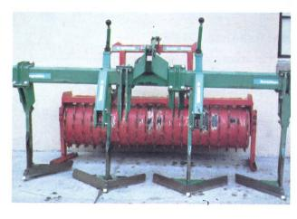
Als Pflugsatz arbeitet die Pendelspatenmaschine schonungsvoll, indem sie eine grobschollige Bodenstruktur ohne Verdichtungshorizonte an der Bearbeitungsgrenze hinterlässt. Ihr Einsatz ist vor allem auf schweren und «nassen», von Radspuren zerfurchten Böden nach späterräumenden Kulturen (zum Beispiel Zuckerrüben) zu empfehlen.
