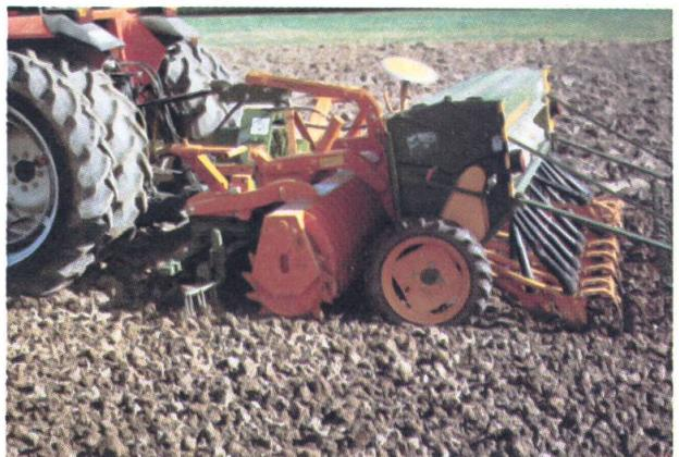
*Mit einer speziell konzipierten Streifenfrässämaschine wird in einem Arbeitsgang ein 10 cm breiter Streifen bearbeitet und rückverfestigt, in welchen das Staatgut von Hackfrüchten abgelegt wird. Die aus Pflanzenresten bestehend Mulchschicht vermindert den Boden- und Nährstoffabtrag und verbessert das Wasseraufnahmevermögen sowie die Bodentragsfähigkeit.*
