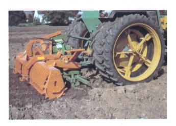
Die Rüttelegge, das bodenschonendste der zapfwellengetriebenen Geräte, zeichnet sich durch ihre einebnende Wirkung und den geringen Leistungsbedarf aus. Sie eignet sich zur Saatbettbereitung auf mittelschweren und leichteren, gepflügten Böden. Die mit grossem Durchmesser konzipierte Packerwalze dient zur Tiefenregulierung. Gleichzeitig trägt sie durch ihre Belastung und derjenigen der doppelbalkigen Rüttelegge zur weiteren Zerkleinerung und zur effektvollen Rückverfestigung des Bodens bei . . .
