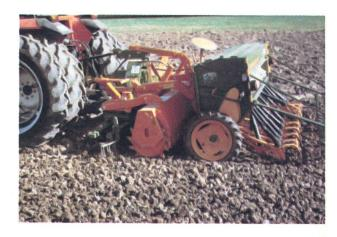
Mit einer speziell konzipierten Streifenfrässämaschine wird in einem Arbeitsgang ein 10 cm breiter Streifen bearbeitet und rückverfestigt, in welchen das Staatgut von Hackfrüchten abgelegt wird. Die aus Pflanzenresten bestehend Mulchschicht vermindert den Boden- und Nährstoffabtrag und verbessert das Wasseraufnahmevermögen sowie die Bodentragfähigkeit.
