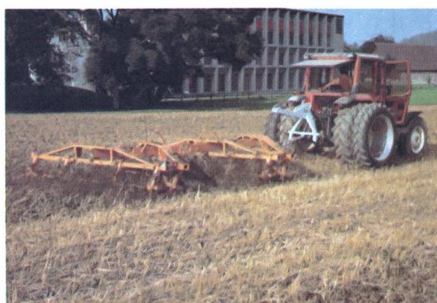
*Mit einer Spatenrolle schwerer Bauweise, bestehend aus vier hintereinander angeordneten Spatenschwellen, kann auch auf schwer zu bearbeitendem Boden eine intensive Krümel- und Mischwirkung in einem Arbeitsgang erzielt werden. Nebst der Stoppelbearbeitung ist ein bodenschonender Einsatz zur Saatbettbereitung möglich. Mit einer nachlaufenden Packerwalze gekoppelt, wird nebst dem Einebnen eine Rückverfestigung der grobkrümeligen Oberfläche erreicht.*
