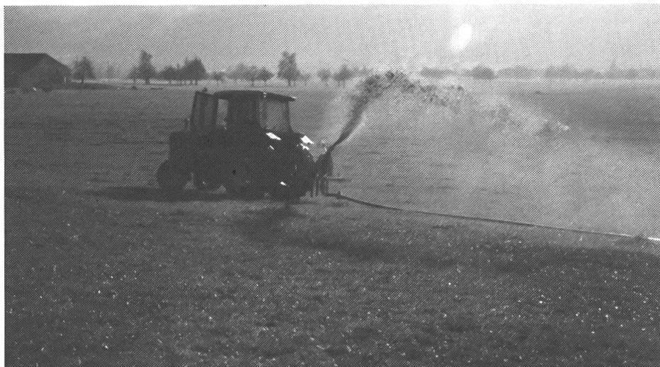
Abb. 1: Mit einem gut eingestellten Verteiler ist eine ausgeglichene Verteilung möglich. Die Rohrleitung von 100 bis max. 300 m Länge wird bei langsamer Fahrt (rund 1 km/h) mitgezogen.
