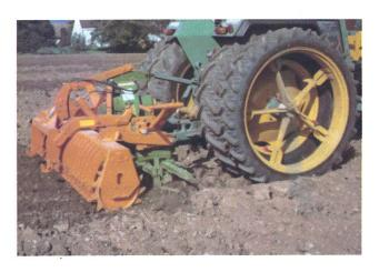
Mit einer Spatenrollegge schwerer Bauweise, bestehend aus vier hintereinander angeordneten Spatenwellen, kann auch auf schwer zu bearbeitendem Boden eine intensive Krümelund Mischwirkung in einem Arbeitsgang erzielt werden. Nebst der Stoppelbearbeitung ist ein bodenschonender Einsatz zur Saatbettbereitung möglich. Mit einer nachlaufenden Packerwalze gekoppelt, wird nebst dem Einebnen eine Rückverfestigung der grobkrümeligen Oberfläche erreicht.
