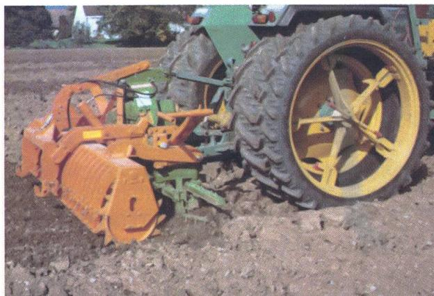
Mit einer Spatenrolle schwerer Bauweise, bestehend aus vier hintereinander angeordneten Spatenwellen, kann auch auf schwer zu bearbeitendem Boden eine intensive Krümel- und Mischwirkung in einem Arbeitsgang erzielt werden. Nebst der Stoppelbearbeitung ist ein bodenschonender Einsatz zur Saatbettbereitung möglich. Mit einer nachlaufenden Packerwalze gekoppelt, wird nebst dem Einebnen eine Rückverfestigung der grobkrümeligen Oberfläche erreicht.
