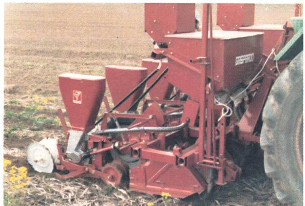
Mit einer speziell konzipierten Streifenfrässämaschine wird in einem Arbeitsgang ein 10 cm breiter Streifen bearbeitet und rückverfestigt, in welchen das Staatgut von Hackfrüchten abgelegt wird. Die aus Pflanzenresten bestehende Mulchschicht vermindert den Boden- und Nährstoffabtrag und verbessert das Wasseraufnahmevermögen sowie die Bodentragfähigkeit.
