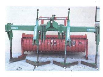
Verstellbare Räumscheiben mit Tastrad vor dem Säaggregat einer herkömmlichen Einzelkornsämaschine ermöglichen eine verstopfungsfreie Mulchsaat. Bei dieser Hackfrucht-Direktsaat in einen unbearbeiteten Pflanzenmulch (= bestmöglicher Erosionsschutz) sind jegliche Fahrspuren von der Zwischenfruchtsaat bis zur Hauptfruchtsaat im folgenden Frühjahr zu vermeiden.
