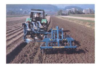
Krummenpacker als Pflugnachläufer werden vorzugsweise auf leichteren, humosen Böden eingesetzt. Sie bewirken ein mechanisches Absetzen des Bodens (Bodenschluss) sowie eine grössere Tragfähigkeit. Packerkombinationen (zum Beispiel Wendepacker mit Crosskillwalze) können im Idealfall gleichzeitig mit dem Pflügen das Feld saatfertig vorbereiten.
