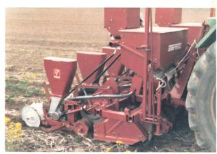
Mit einer speziell konzipierten Streifenfrässämaschine wird in einem Arbeitsgang ein 10 cm breiter Streifen bearbeitet und rückverfestigt, in welchen das Staatgut von Hackfrüchten abgelegt wird. Die aus Pflanzenresten bestehende Mulchschicht vermindert den Boden- und Nährstoffabtrag und verbessert das Wasseraufnahmevermögen sowie die Bodentragfähigkeit.
