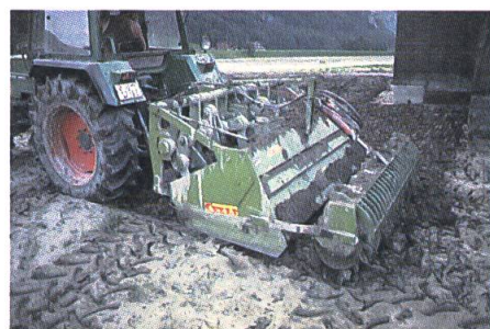
Mit der Spatemaschine wird die abgelagerte Materialschicht mit dem darunterliegenden Boden vermischt.
