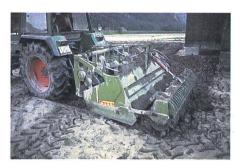
Mit der Spatemaschine wird die abgelagerte Materialschicht mit dem darunterliegenden Boden vermischt.
