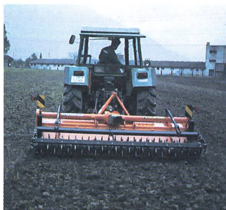
Herrichten des Saatbettes mit einer Zinkenrotoregge.
