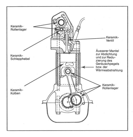
Kühlsystem, erhöhen sich die Temperaturen an den Wänden der Verbrennungskammer von 150 auf 800 Grad Celsius. Damit sie so hohe Temperaturen aushalten können, werden Verbrennungskammern in Zukunft aus hochentwickeltem Keramikmaterial hergestellt werden müssen.
