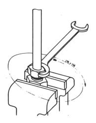
Verbindung lösen und Schneidring-Einschnitt prüfen
