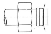
Verschraubung definitiv montieren und unter normalem Kraftaufwand festziehen.
