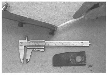
Der Aussenrand der Mähklingenhalterung darf an der im Bild angezeichneten Stelle nicht geschwächt sein. Der Bolzendurchmesser soll im Minimum noch 8 Millimeter betragen.
