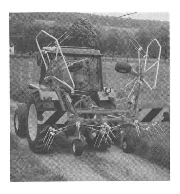
Kreiselheuer, die sich seitlich hochklappen lassen, bieten arbeits- und sicherheitstechnische Vorteile. Maschinen, an denen sich die Kreisel beim Anheben nach innen drehen damit keine Spitzen vorstehen, sind für die Strassenfahrten vorzuziehen. Doch auch bei dieser Variante müssen vom Verkäufer gelb/ schwarze Tafeln und Rückstrahler angebracht werden.
