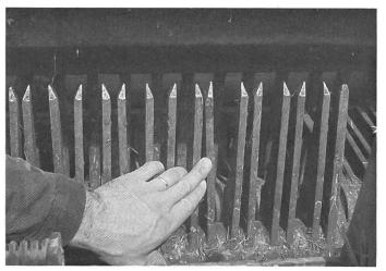
Der zusammengedrückte Doppelzinken beschädigt das Schneidemesser und verursacht Schläge auf die Lager des Förderorgans.
