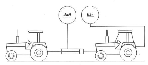
1: Prüfung der hydraulischen Bremsen am Traktor
