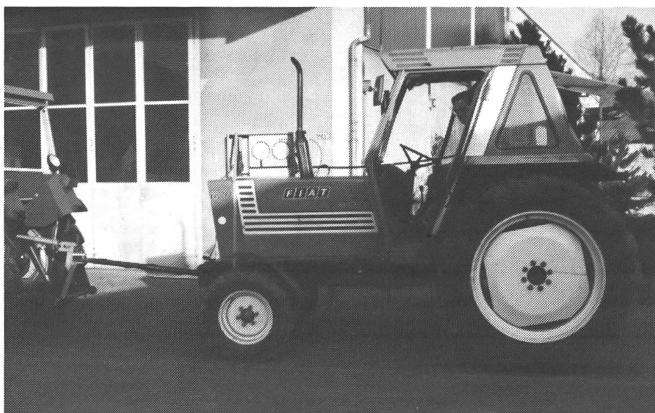
5: Indirekte Messung der Bremsleistung am Traktor.
