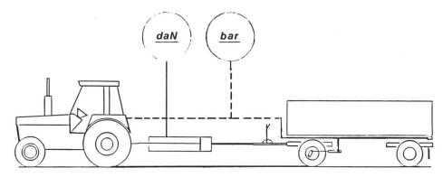
2: Prüfung der hydraulischen Bremsen am Anhänger
