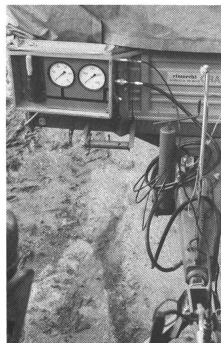
4: Überprüfung der Bremsleistung an einem Einachsanhänger. Erkennbar sind die beiden Manometer für die Bestimmung des Bremsdruckes und der Bremskraft und am unteren Bildrand der Messzylinder zwischen Anhänger und Traktor.
