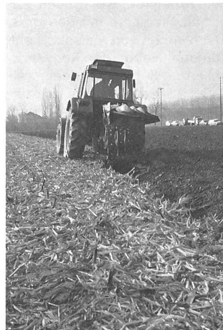
2: Die Wendearbeit sämtlicher vorgeführter Pflüge vermochte zu befriedigen. Gelegentlich traten als Folge der Ernterückstände Verstopfungsprobleme auf.
