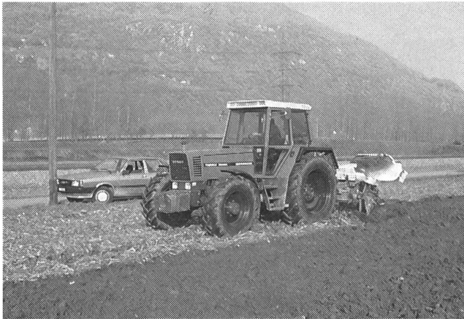
3: Vierscharpflug, bei dem der Traktor ausserhalb der Furche fährt. Unter den herrschenden Bedingungen vermochte die erzielte Arbeit voll zu befriedigen.
