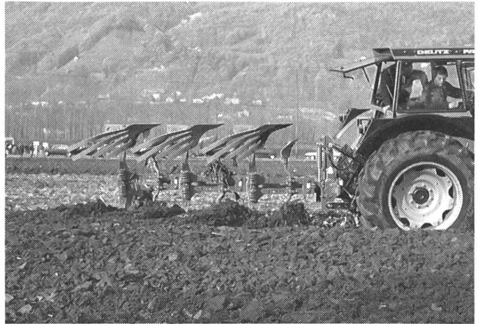
4: Nur ein einziger Pflug mit Streifenriestern wurde vorgeführt. – Nach den Versuchsergebnissen der FAT weisen die Streifenriester gegenüber den Standardriestern keine nennenswerte Vorteile auf.
