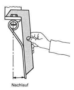
Abb. 3: Abweichungen am Zinken-Anstellwinkel von wenigen Graden entscheiden weitgehend das Zettbild.
