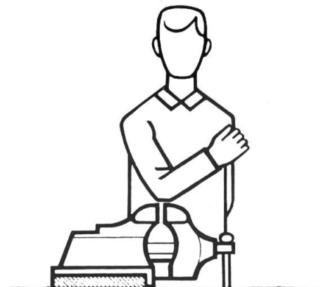
Skizze 3: Ergonomisch richtige Höhe des Schraubstockes.
