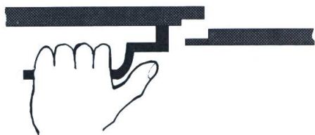
Skizze 1: Diese Form des Türgriffes hilft Daumenverletzungen zu vermeiden.
