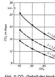
Abb. 3: CO<sub>2</sub>-Gehalt der trockenen Abgase bei verschiedenen Luftüberschusszahlen nach der Verbrennung eines CH<sub>4</sub>/CO<sub>2</sub>-Gemisches mit 2% Stickstoff Luftüberschusszahl (λ) = tatsächlich vorhandene Luftmenge
