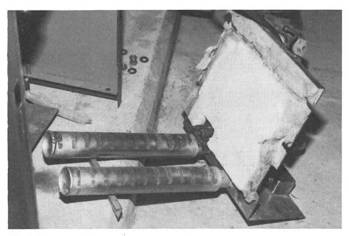
Die beiden ausgebauten Hauptbrenner. Darüber ist die Austrittsöffnung des Gases für die Pilotflamme zum Zünden der Hauptbrenner sowie das Thermoelement zur Unterbrechung der Gaszufuhr im Falle einer Störung in der Brennkammer erkennbar.
