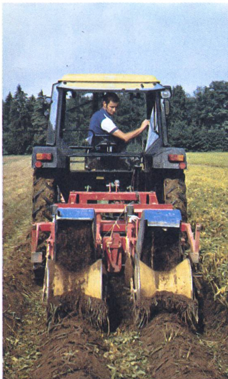
Krautzupfmaschine Oldenhuis in einem Saatkartoffelfeld. Die Kartoffelstauden werden von gegeneinandergepressten Gummibälgen vor den beiden Anpressrollen erfasst und ausgerissen.
