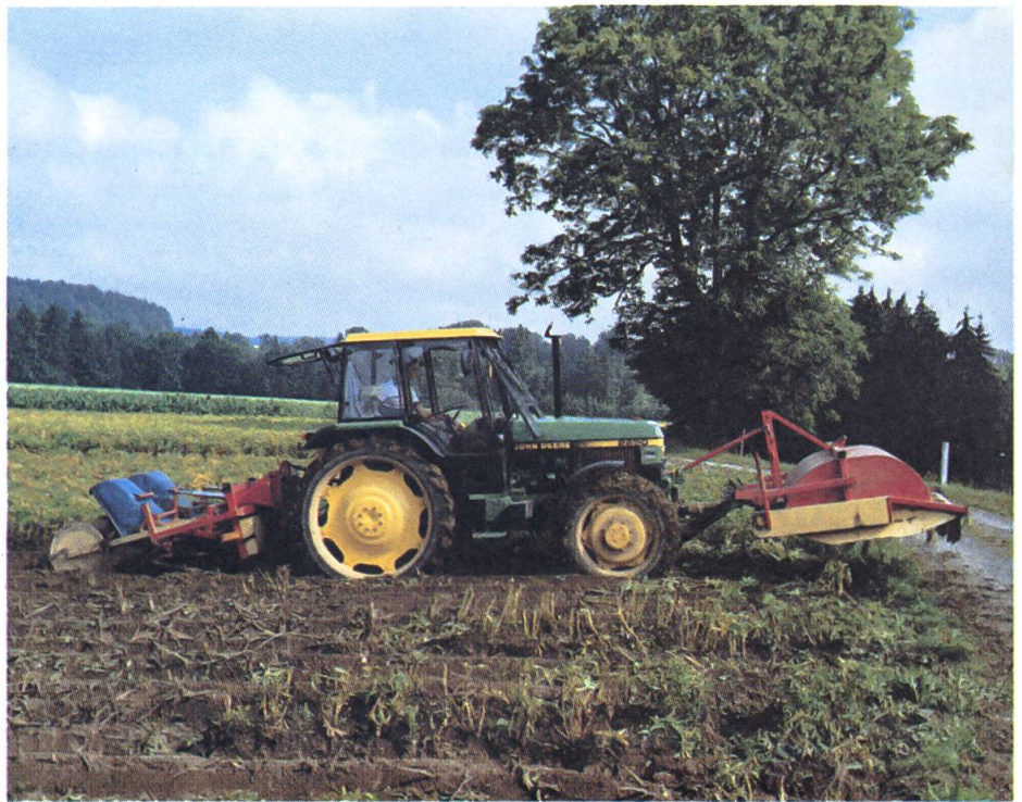
Vor dem Traktor läuft der Krautschläger. Das abgeschlagene Kraut wird zwischen den Reihen abgelegt. Die Erfahrung zeigte, dass die stehengebliebenen Stengelteile nachträglich noch verdorrten und die Qualität des Saatgutes nicht beeinträchtigten.
