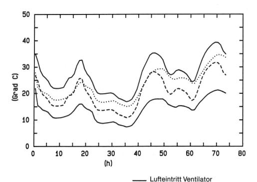
Abb. 7: Versuch-Nr. 1, Verlauf der Lufttemperaturen über die Versuchsdauer.
