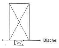
Balkenhöhe entspricht dem nötigen Durchlass. Unterzug aus Blachenmaterial. Besonders geeignet bei Sparrendächern und in Altbauten.
