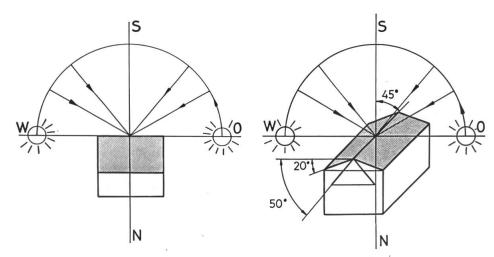
Abb. 3: Je nach Dachneigung und Exposition (Stellung des Daches zur Sonne) kann ein mehr oder weniger grosser Teil des Sonnenlichtes ausgenutzt werden. Die beste Ausnützung ergibt sich bei einer Neigung von 20° und einer Exposition nach Süden. Aber auch Ost- und Westdächer können noch 70 bis 90 % der Leistung eines Süddaches erbringen.
