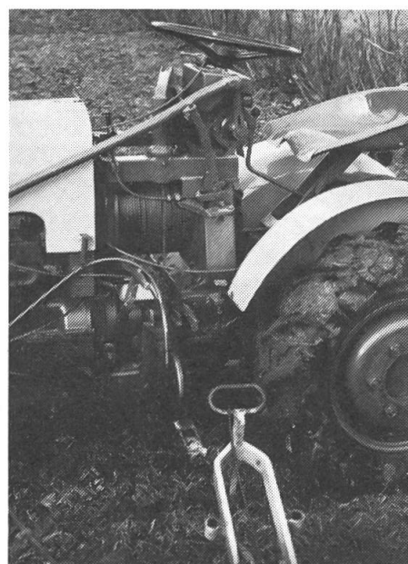
Grössere Sicherheit mit dem Seilzug – aufgebaut auf einen Weinbautraktor.
