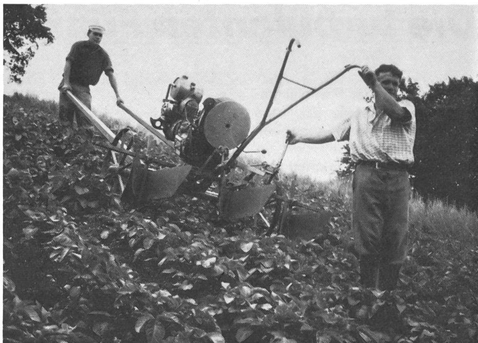
Die Umstellung auf den Anbau in der Falllinie ebnete den Weg für die Mechanisierung des Hangackerbaus.
