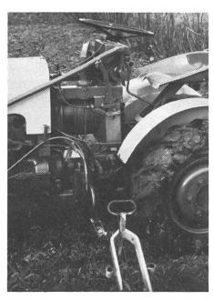
Grössere Sicherheit mit dem Seilzug – aufgebaut auf einen Weinbautraktor.
