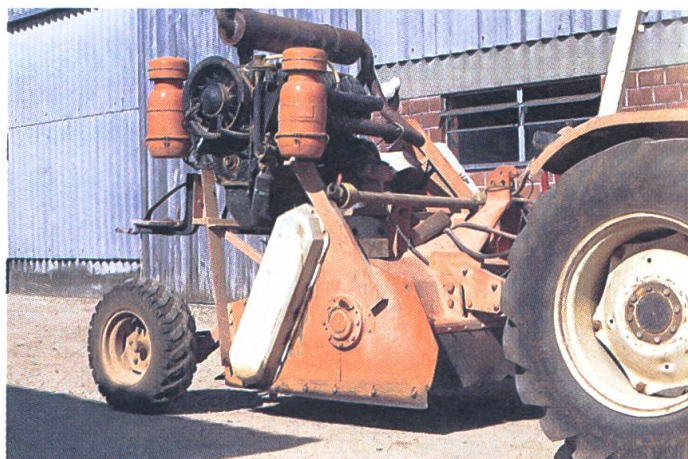
Die Maschine frisst auch grosse Brocken. Das Volumen des fruchtbaren Oberbodens bleibt erhalten.
