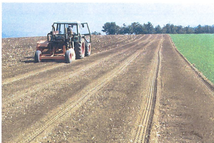
Die Maschine frisst auch grosse Brocken. Das Volumen des fruchtbaren Oberbodens bleibt erhalten.
