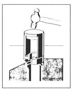
2: Beim Einbau eines Lagers mit festem Sitz im Gehäuse sollte eine Schlagkappe, die gegen den Aussenring anliegt, verwendet werden. Den Lagersitz im Gehäuse mit dünnem Öl bestreichen.
