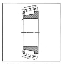
7: Rollenkranz des Kegelrollenlagers gut einfetten
