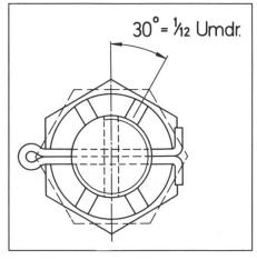
9: Die Mutter wird um höchstens ½12 Umdrehung bis zur Deckung mit dem Splintloch zurückgedreht.
