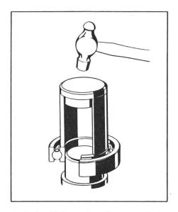
1: Beim Einbau eines Lagers mit festem Sitz auf der Welle ist eine Schlagkappe, die gegen den Innenring anliegt, zu wählen. Um den Einbau zu vereinfachen und Beschädigungen zu vermeiden, sollte die Lagersitzfläche mit dünnem Öl bestrichen werden.
