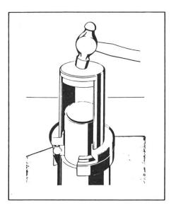
3: Wenn ein selbsthaltendes Lager gleichzeitig auf die Welle und in das Gehäuse eingebaut werden muss, ist eine Schlagkappe mit Anlagefläche für beide Lagerringe erforderlich. Beide Lagersitze sollten vor dem Einbau eingeölt werden. Wenn der Bohrungsdurchmesser der Lager zwischen 10 und 50 mm liegt, kann ein Einbauwerkzeugsatz für die drei oben erwähnten Einbaufälle verwendet werden.
