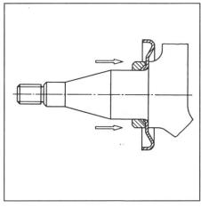
8: Nach der Schutzkappe wird der Zwischenring auf den Achsschenkel geschoben.
