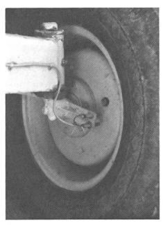
Je grösser die Drehzahl, um so mehr Messimpulse entstehen. Der Induktivgeber nimmt diese Messimpulse direkt vom Impulsgeber (Scheibe, Zahnrad) auf.
