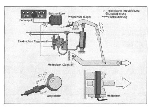
Schematische Darstellung der elektronischen Hubwerkregelung (EHR) (nach Bosch).
