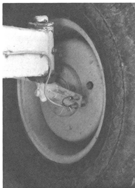
Je grösser die Drehzahl, um so mehr Messimpulse entstehen. Der Induktivgeber nimmt diese Messimpulse direkt vom Impulsgeber (Scheibe, Zahnrad) auf.
