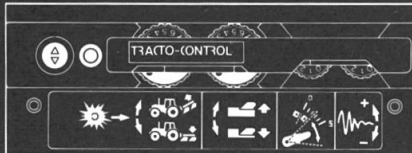
Elektronische TRACTO CONTROL Präzise Mikroprozessoren-Steuerung der Hydraulik für höchste Leistung bei optimalem Anwenderkomfort.
