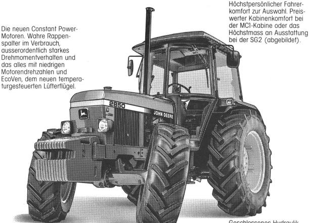
Extrem wendige Allrad-Traktoren durch den unvergleichlichen 12-Grad-Nachlaufwinkel. Auf Fingertip unter Last schaltbar. Automatisches Selbstsperrdifferential.
