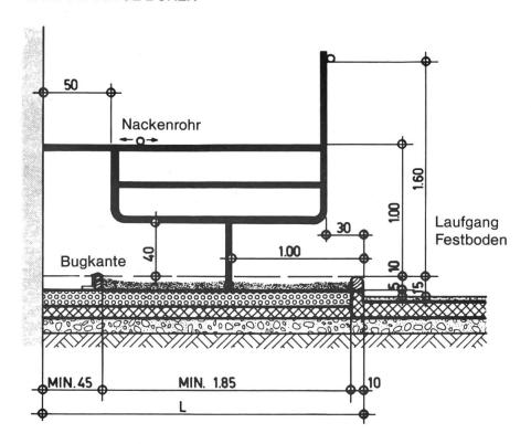
Abmessungen gemäss Tierschutzverordnung (Lichte Masse) Boxenbreite 120 cm Boxenlänge L
