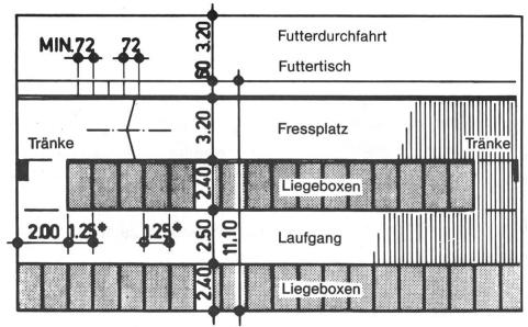
Abb. 3: Anordnung der Liegeboxen; Abmessungen Laufgänge und Boxen.
