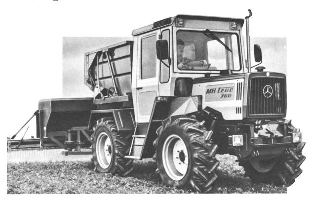
Wenn im Frühjahr unter Zeitdruck gearbeitet wird, sind die Qualitäten eines Schleppers entscheidend. Deshalb hat der MBtrac einen echten Allradantrieb mit zwei gleich starken Achsen, 100% ig wirkenden Klauendiffe-
