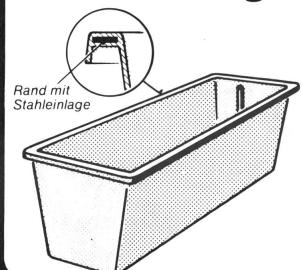
Behälter aus glasfaserverstärktem Polyester. Besonders stabil, dauerhaft, dickwandig, Stahlrahmen verstärkt, witterungsbeständig
