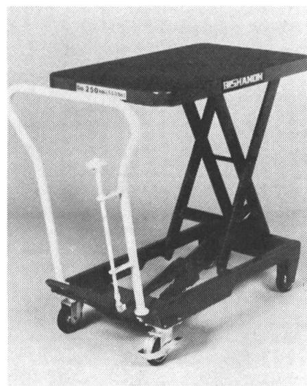
Gegenüber dem normalen Magazin- oder Tischwagen verfügt der Hubtischwagen über eine höhenverstellbare Ladefläche. Diese Anpassungsmöglichkeit an die ideale Arbeitshöhe schafft Arbeitserleichterung und rationalisiert das Handling in Lager, Spedition, Werkstatt, Labor, Warenhaus und Einkaufszentren. Hubtischwagen nehmen nicht mehr Platz in Anspruch als die üblichen Magazin- und Tischwagen, können also auch dort eingesetzt werden, wo prekäre Platzverhältnisse herrschen.
