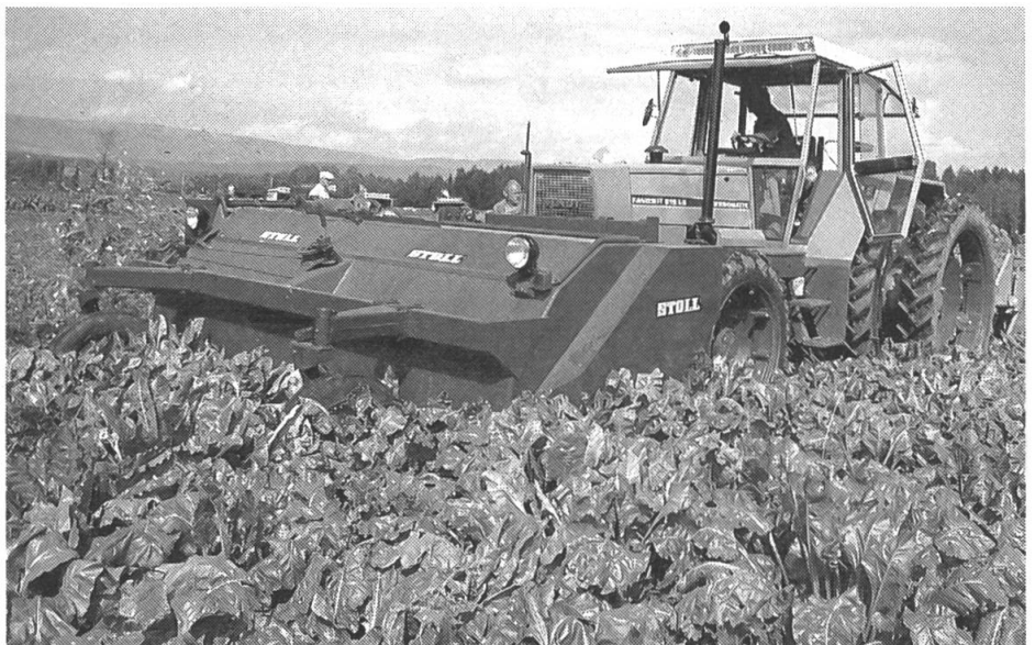
5: Vorne köpfen und putzen, hinten roden und ablegen in einen Längsschwad.
