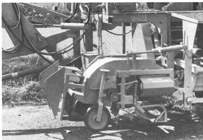
Wird auf das Blatt verzichtet, können die Maschinen mit einem Kreiselköpfer, der das Blatt breit verteilt und einem Kufentastnachköpfer mit Köpfdickenautomatik ausgerüstet werden.
