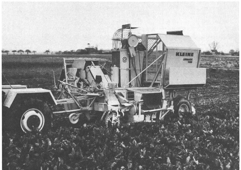
1 Bei dieser Maschine befindet sich die Blattbergevorrichtung vor dem Bunker im Blickfeld des Fahrers. Fotos: H. Krebs und Werkaufnahmen
