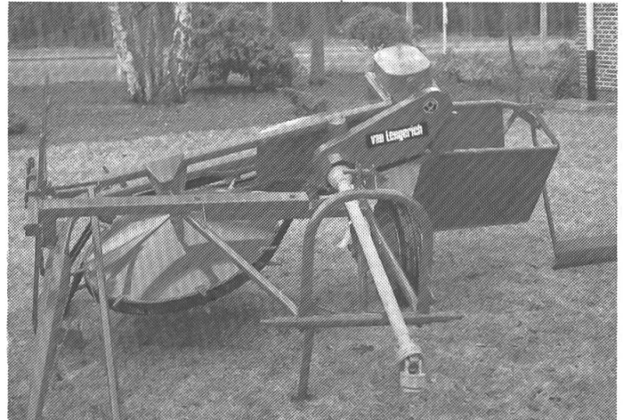
Abb. 5: Ziehmaschine für Rüben-Reihen- und Blatt-Querschwadablage (BvL).
