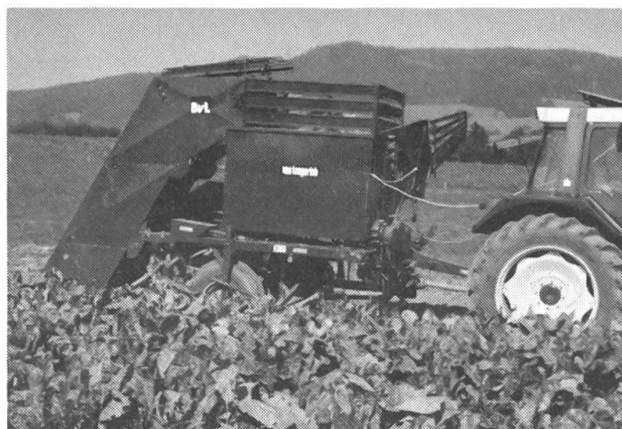
Abb. 11: BvL-Super. Futterrübenvollernter (REB, einreihig) mit Lockerungsschar, Raufriemen-Ziehsystem, festem Köpfmesser, Siebband, Mitnehmerelevator, Rollbodenbunker, Lenkautomatik, ca. 2100 kg, ca. Fr. 28500.–.
