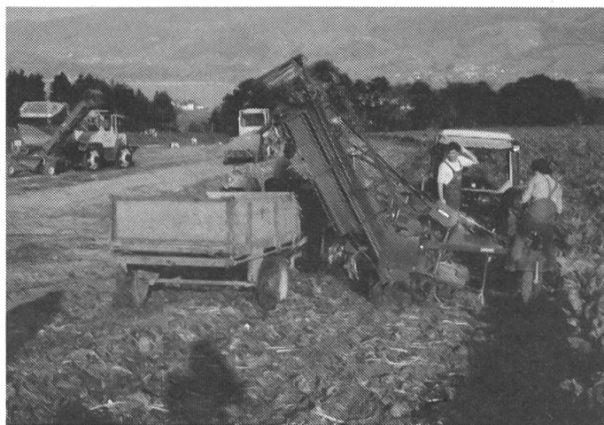
Abb. 9: BvL-RE 2000, Futterrübenrodelader (REL+T, einreihig) mit Lockerungsschar, Raufriemen-Ziehsystem, festem Köpfmesser, Siebrad, Mitnehmerladeelevators, Lenkvorrichtung für Bedienungsperson, ca. 1080 kg, ca. Fr. 10400.-.
