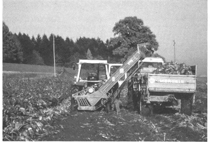
Abb. 3: Dänisches Erntesystem mit Schlegelhäcksler und Rodelader (K+RL). Eine in der Höhe individuelle Entblätterung ist hier nicht möglich. Sorten mit unregelmässigem Sitz eignen sich nicht für dieses System.
