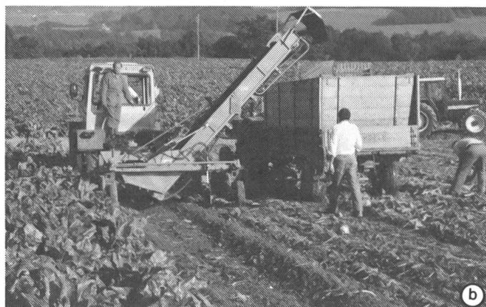
b) Carré ACH 85. Rodelader (RL, dreireihig) mit Winkelscharen, Reinigung über zwei Siebräder, Tragförder-Ladeelevators, ca. 740 kg, ca. Fr. 13000.-.
