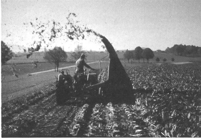
Abb. 3: Dänisches Erntesystem mit Schlegelhäcksler und Rodelader (K+RL). Eine in der Höhe individuelle Entblätterung ist hier nicht möglich. Sorten mit unregelmässigem Sitz eignen sich nicht für dieses System.
