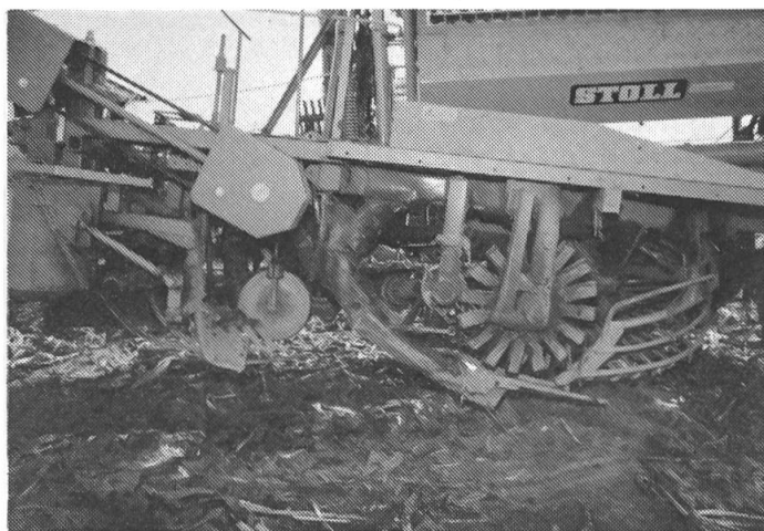
Abb. 7: Rodegruppe des Stoll KN Vollernters. Für die Futterrüben-ernte wurde der Schardurchgang vergrößert und ein Gummi-Seitenstern eingebaut. Der Typ KS verfügt über Schwingrodekörper.
