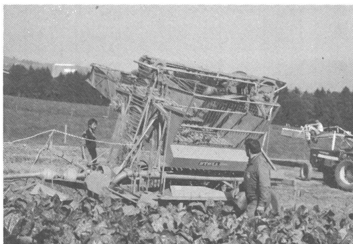
Abb. 15: Stoll V50KN/KS. Zuckerrübenvollernter mit Kreis- und Nachlaufköpfer, Längsputzer, Polderschar (KN = starr, KS = Schwingrodekörper), Seitenstern, Siebrad, Tragförderellevator, Rollbodenbunker, Lenk- und Tiefenautomatik, ca. 2350 kg, Fr. 46000.- bis Fr. 49000.-.
