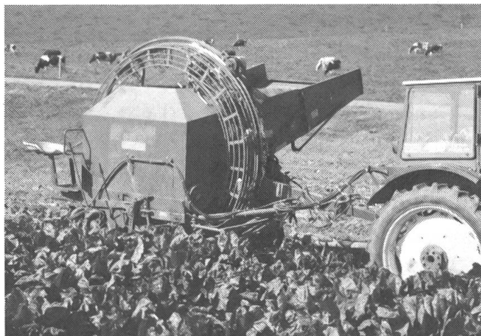
Abb. 14: Kemper. Futterrübenvollernter (REB) mit Lockerungsschar, Raufriemen-Ziehsystem, eine rotierende Schneidscheibe, ein Siebrad, Ringelevator, Rollbodenbunker, Steuerung vom Traktor aus, ca. 1900 kg.
