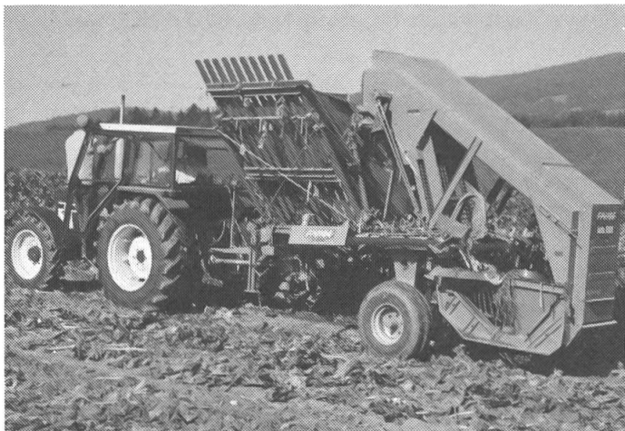
Abb. 13: Fähs Beta 1506. Futterrübenvollernter (REB) mit Lockerungsschar, Raufriemen-Ziehsystem, 1985 einfache-, 1986 doppelwirkende Putzschleuder (auf den Rübenkörper einwirkend), zwei gegenläufige Schneidscheiben (Antrieb einfach), Mitnehmerelevator, Kippbunker, Lenkautomatik, ca. 2100 kg, ca. Fr. 28000.-.
