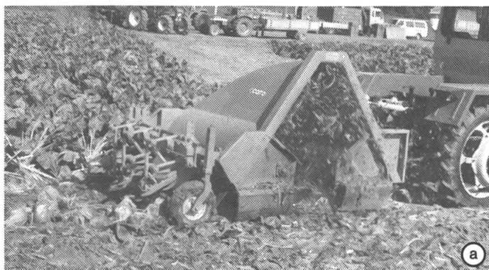
a) Carré GL 85. Gezogener Schlegelköpfer für Futterrüben (K, dreireihig), zwei gegenläufige Gummischlegelwalzen, Blattauswurf seitlich, ca. 635 kg, ca. Fr. 7500.-.
