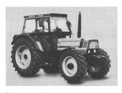
Der neue 6-Zylinder-Traktor DX 6.05 von DEUTZ-FAHR mit 98 PS.
