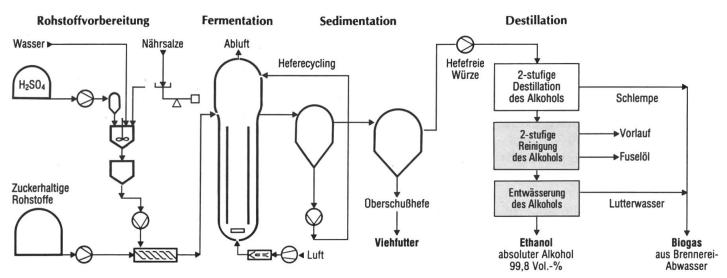
Abb. 1: Schema der Biosprit-Versuchsanlage der Zuckerfabrik Franken, Ochsenfurt (BRD) für eine Tageskapazität von 15 000 l Ethanol.
