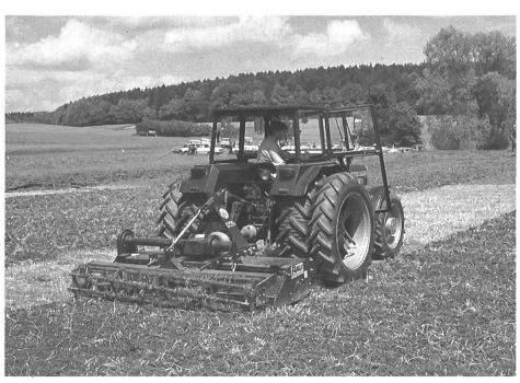
Die Bodenfräse garantiert eine optimale Vermischung von Bodenmaterial und Strohresten.
