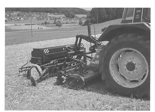
Gerätekombination Bodenfräse mit Säapparat.
