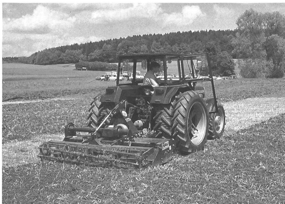
Die Bodenfräse garantiert eine optimale Vermischung von Bodenmaterial und Strohresten.
