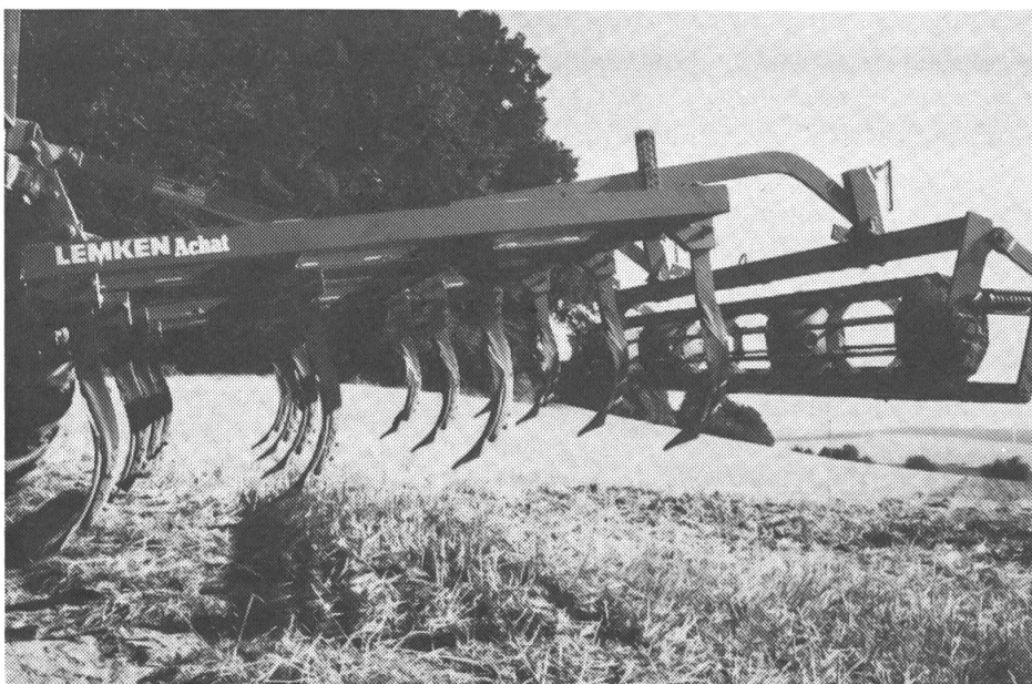
Durch die Doppelherzform der Schare wird eine besonders gute Schüttung der Ackerkrume erzielt. Grubber werden mit Vorteil mit einem Nachlaufgerät kombiniert.
