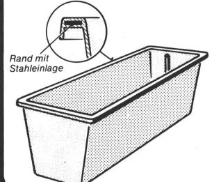
Behälter aus glasfaserverstärktem Polyester. Besonders stabil, dauerhaft, dickwandig, Stahlrahmen verstärkt, witterungsbeständig
