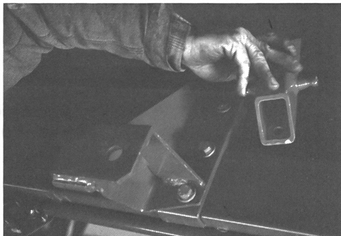
Abb. 6/7: Bei einem grossen Teil der Transporter entspricht der Geräteaufbau der SN-Norm. Für den Aufbau von Geräten anderer Marken müssen lediglich die vier Anschlusssteile am Gerät gewechselt werden. Dieser Wechsel ist mit einfachen Werkzeugen möglich.
