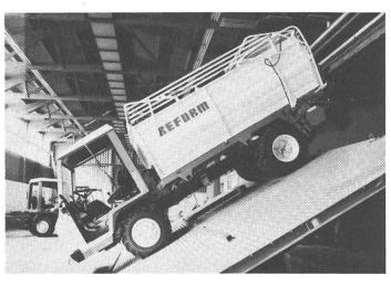
Abb. 4: Messung der Handbremse: Die Handbremse wird mit 40 daN(kp) angezogen. Anschliessend wird das voll beladene Fahrzeug auf der Kippbühne solange angehoben, bis es zu rollen beginnt.
