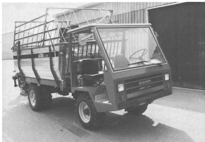
Abb. 6/7: Bei einem grossen Teil der Transporter entspricht der Geräteaufbau der SN-Norm. Für den Aufbau von Geräten anderer Marken müssen lediglich die vier Anschlusssteile am Gerät gewechselt werden. Dieser Wechsel ist mit einfachen Werkzeugen möglich.
