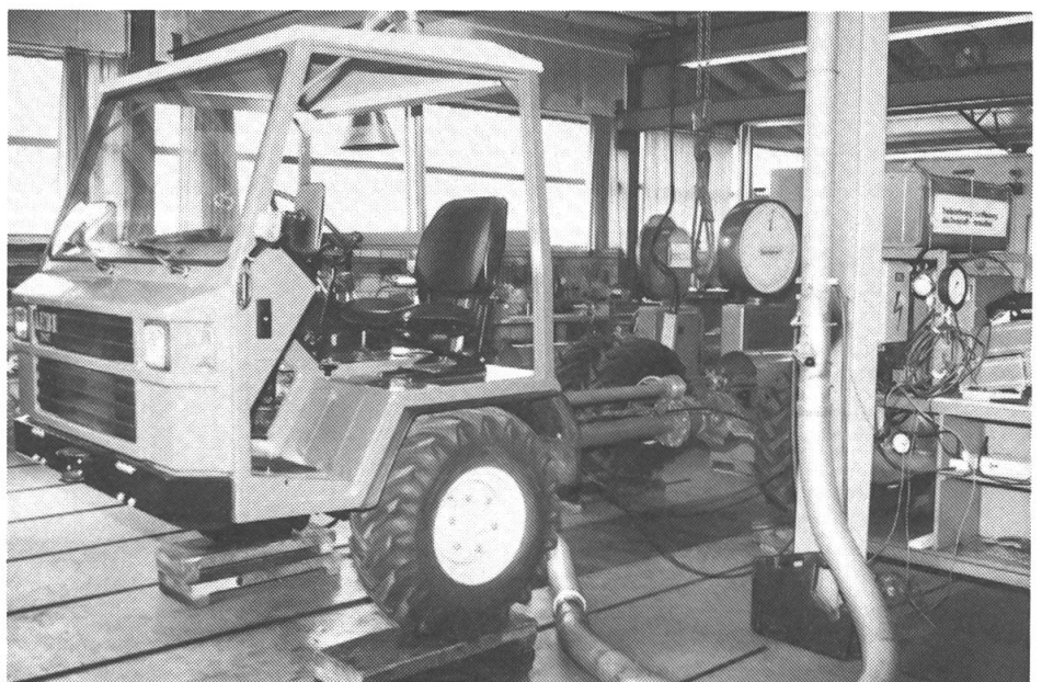
Abb. 1: Die Messung der Leistung an der Zapfwelle gibt die für den praktischen Einsatz verfügbare Leistung wieder. Die Hersteller geben die Motorleistung an, welche in der Regel um rund 10% höher ist, da sie die Verluste im Getriebe und durch den Antrieb von Hydraulikpumpen usw. nicht berücksichtigt.
