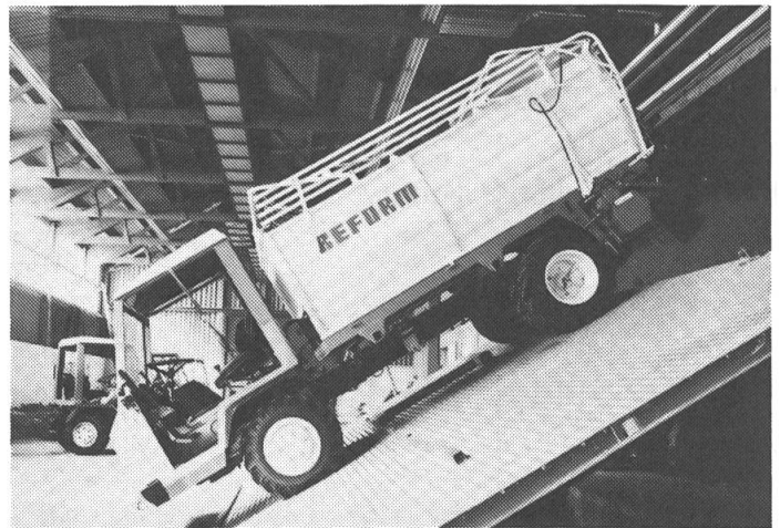
Abb. 4: Messung der Handbremse: Die Handbremse wird mit 40 daN(kp) angezogen. Anschliessend wird das voll beladene Fahrzeug auf der Kippbühne solange angehoben, bis es zu rollen beginnt.
