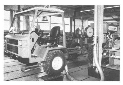
Abb. 1: Die Messung der Leistung an der Zapfwelle gibt die für den praktischen Einsatz verfügbare Leistung wieder. Die Hersteller geben die Motorleistung an, welche in der Regel um rund 10% höher ist, da sie die Verluste im Getriebe und durch den Antrieb von Hydraulikpumpen usw. nicht berücksichtigt.
