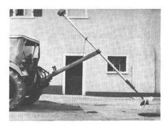
schaftlicher Naturdünger ist. Der neue Zapfwellenmixer Reck mit Zugmaulsteuerung Typ TRE-ZS ist absolut problemlos in der Handhabung und läst sich in Gruben mit Öffnungen ab 50 cm ein- und ausschwenken.
