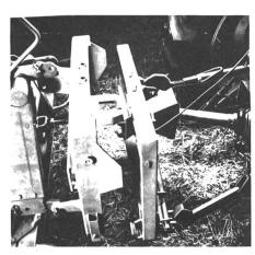
Das System ARAMTIC erlaubt das An- und Abkuppeln von Geräten vom Traktorsitz aus. Auch die Zapfwelle und die Ölhydraulik wird automatisch gekoppelt.
