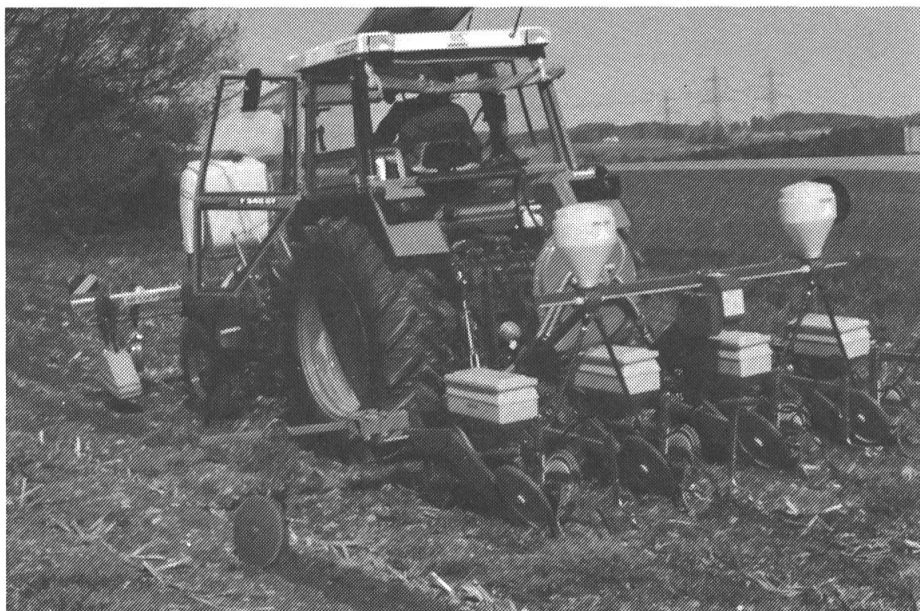
Direktsaatverfahren, wie es der VOLG Winterthur in dieser Saison testet. Deutlich erkennbar sind an der Front des Geräteträgers ein Element der Reihenfräse und der Pflanzenschutzmitteltank für die Bandspritzung. Am Heck befinden sich die pneumatisch arbeitenden Säaggregate mit Scheibensech und Zustreicher sowie die Düsen für die Bandspritzung. Als nachteilig für eine exakte Arbeit wurde an dieser Geräteanordnung die grosse Distanz zwischen Reihenfräse und Sämaschine taxiert.
