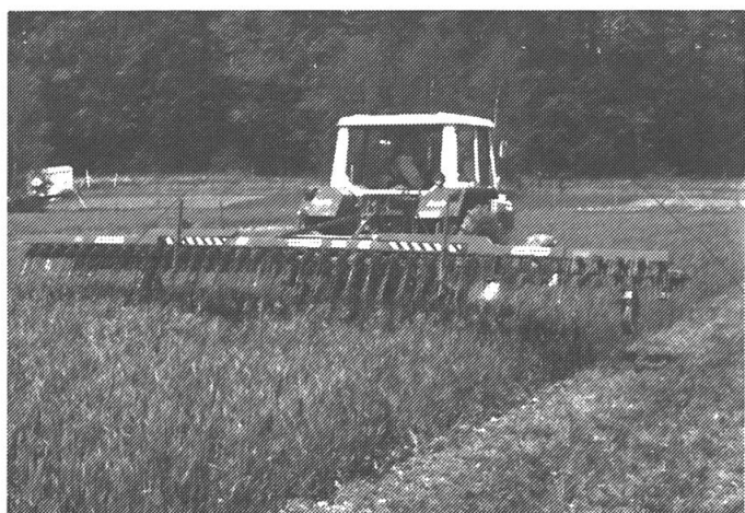
Einsatz des Raabe-Hackstriegels im kniehohen Kornbestand. Das Gerät wird auch mit Gänsescharen für die Hackarbeit im Mais geliefert.
