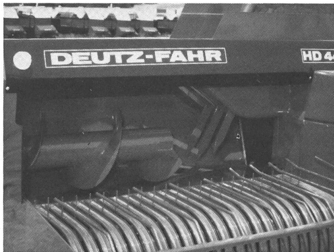
Abb. 2: Kombiniertes Zuführorgan: Schnecke und Raffer.
