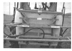
Abb. 4: Einstellung mit Doppeltrapez für einen selbsttätigen Hangausgleich des Spritzgestänges (Berthoud).
