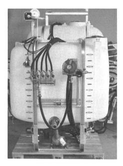
Abb. 1: Seitlich angeordnete Einfüllöffnung, tiefe Auslaufsicke und gut sichtbare Inhaltsskala sind vorteilhaft (Birchmeier).
