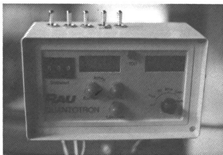
Abb. 9: Monitor eines elektronischen Kontrollgerätes mit gleichzeitiger Anzeige von Fahrgeschwindigkeit (km/h) und Ausbringungsmenge (l/ha).
