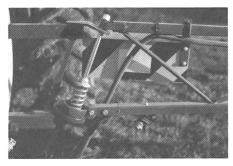
Abb. 3: Das Spiel in den Gestängegelenken soll periodisch kontrolliert und die Feder nachgespannt werden.
