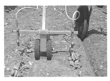
Die Arbeit der hydraulischen Steuerung übernimmt hier ein Tastrad (mit Ringprofil) welches sich von einer kleinen, bei der Saat gezogenen, Furche führen lässt.
