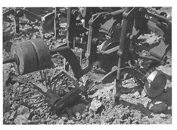
Ein Igelrad, das über die Reihe läuft und der von der Kruste eingeklemmten Rübe Luft zuführt. Das Hackmesser zwischen der Reihe kann dies nicht!
