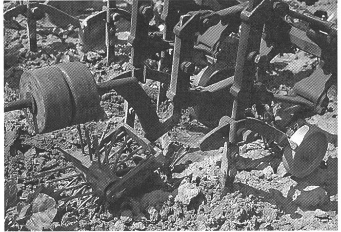
Ein Igelrad, das über die Reihe läuft und der von der Kruste eingeklemmten Rübe Luft zuführt. Das Hackmesser zwischen der Reihe kann dies nicht!
