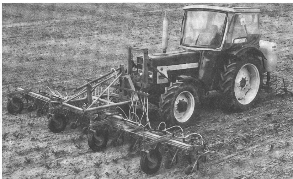
Hacken + Bandspritzen in einem Arbeitsgang. Oft geht diese Kombination aus Zeitgründen nicht. Man kann natürlich die Hackmesser hochstellen, wenn es gilt, noch rasch vor dem abendlichen Regen das Herbizid auszubringen.
