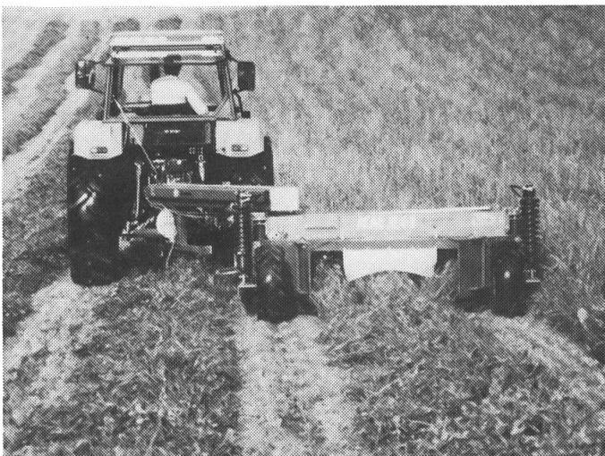
Abb. 2: Dank einfacherer Kraftübertragung sind gezogene Mähwerke heute bedeutend manövrierfähiger als früher.
