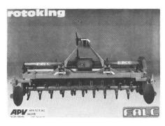
Der neue Keilzinkenrotor Falk Rotoking bearbeitet den Boden sehr schonend und bildet keine Schmierschicht. Die robusten Keilzinken erlauben eine Arbeit sowohl über die Pflugfurche, wie auch direkt über das Stoppelfeld. Alle Ernterückstände werden problemlos in den Boden eingearbeitet. Der Krümeleffekt ist auch in schweren und steinigen Böden einwandfrei. Das Gerät ist mit Vorbaugrubber und/oder Sämaschine ideal kombinierbar zur Minimalbodenbearbeitung.
