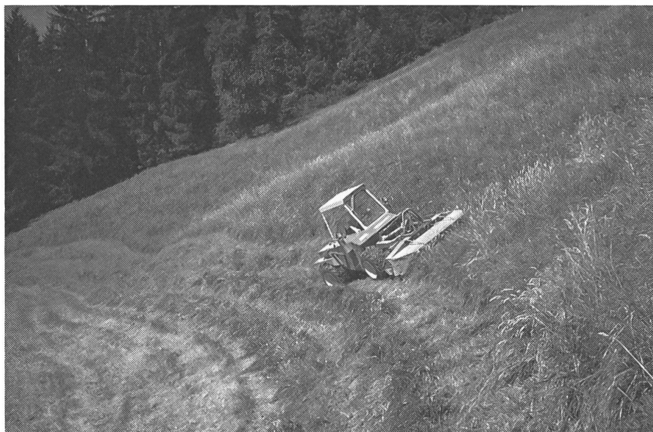
2: Zweiachsmäher sind leistungsfähig und im Futterbaubetrieb vielseitig einsetzbar. Wegen der hohen Kosten ist die Anschaffung nur in grossen Betrieben vertretbar.
