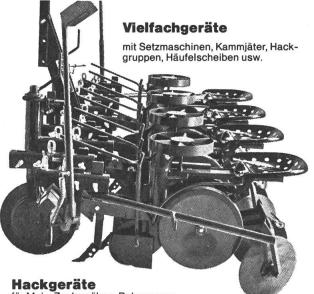
für Mais, Zuckerrüben, Bohnen usw. in verschiedenen Ausführungen. (Sternhackgeräte, Scharhackgeräte mit Schutzscheiben oder Chromstahl-Schutzblechen), für jeden Betrieb den richtigen Typ.
