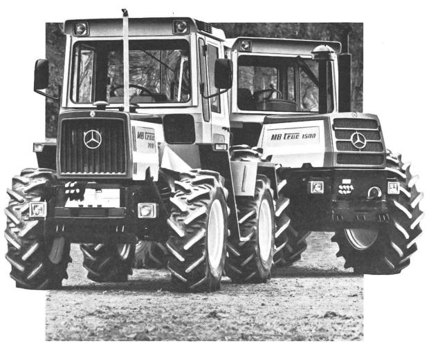
Der MB-trac wird weitergebaut. Darauf können Sie sich verlassen. Das Konzept des MB-trac wird weltweit als richtig anerkannt und von uns ständig weiterentwickelt. Kompromißloser Allradantrieb über vier gleich große Räder sorgt für höchste Zugkraft bei größtmöglicher Bodenschonung. Drei Anbauräume für Geräte sind die Voraussetzung für wirtschaftliche Arbeitsverfahren durch Gerätekombinationen. Diese entscheidenden Konzeptionsvorteile
