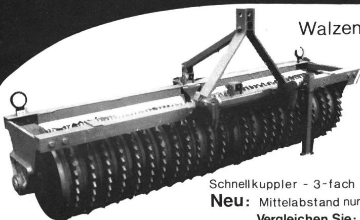
Schnellkuppler - 3-fach Lagerung - Standstütze
