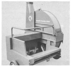
Für die schlagkräftige Silobefüllung sorgen die Siliergebläse EPPLE Turbo.
