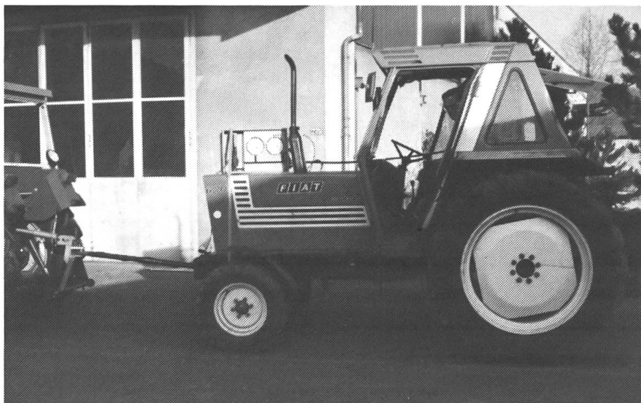
5: Indirekte Messung der Bremsleistung am Traktor.
