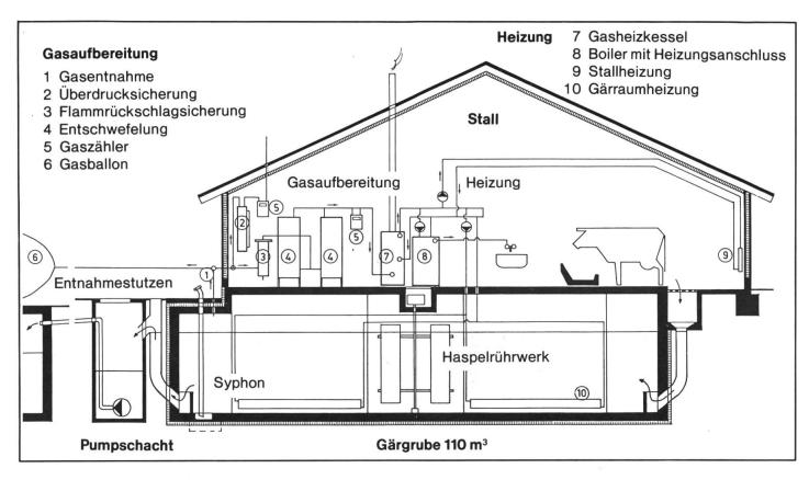
Abb. 3: Skizze der Biogasanlage.
