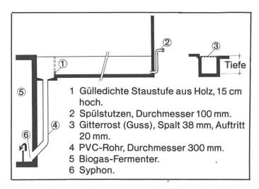
Abb. 4: Skizze der Syphonierung der Treibmistkanäle.
