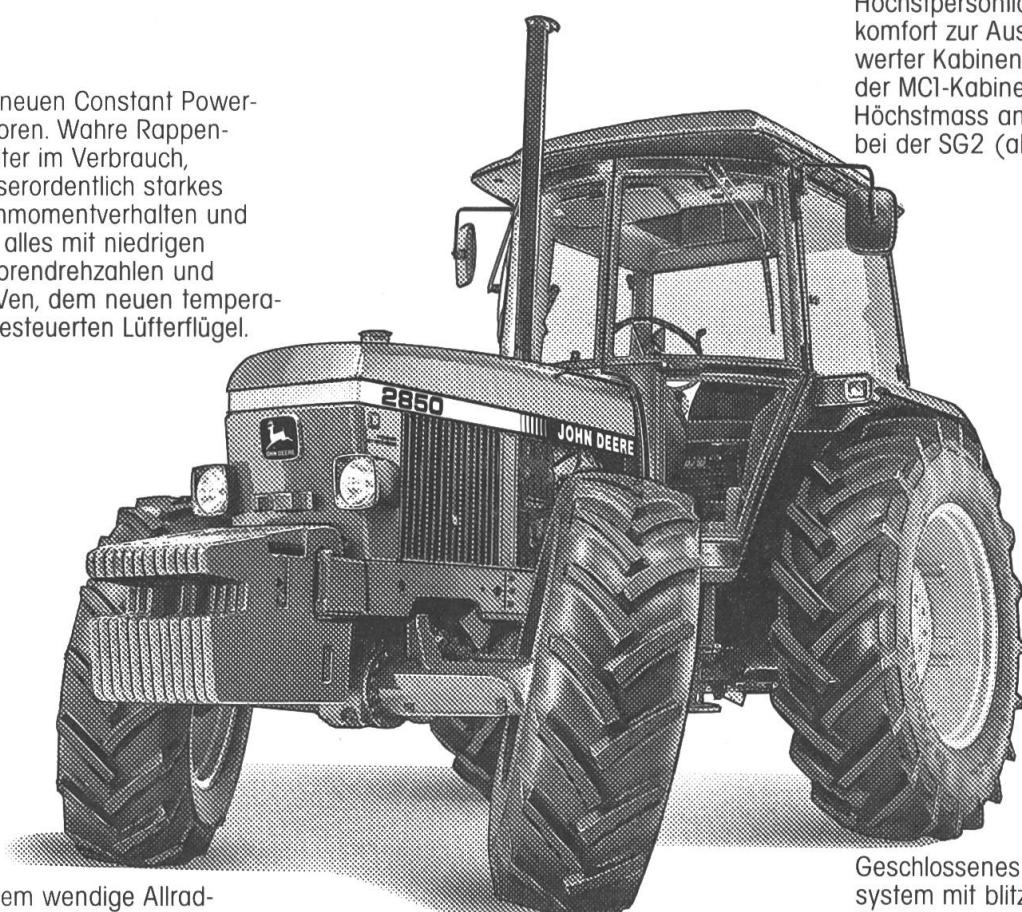
Extrem wendige Allrad-Traktoren durch den unver-gleichlichen 12-Grad-Nachlaufwinkel. Auf Fingertip unter Last schaltbar. Auto-matisches Selbstsperr-differential.
