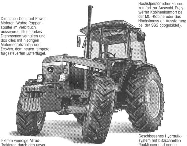
Traktoren durch den unvergleichlichen 12-Grad-Nachlaufwinkel. Auf Fingertip unter Last schaltbar. Automatisches Selbstsperrdifferential.
