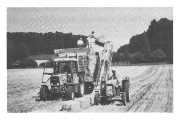
Abb. 4: Lader mit Zapfwellenantrieb.
