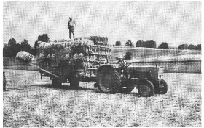
Abb. 2: Ladearm. Dieses Verfahren ist eher selten anzutreffen. Für den kleineren Betrieb hat es jedoch seine Berechtigung. Die Ballen werden von Hand auf den Ladearm gelegt. Sobald das Gewicht der Balle auf den Arm drückt, wird die Hebehraulik durch ein Drahtseil ausgelöst, und die Balle wird auf den Wagen gehoben. Der Arm senkt sich erst wieder, nachdem die Balle abgenommen worden ist. Der Ladearm kann in der Höhe verstellt werden. Das Anbauen ist praktisch an jeden Brückenwagen möglich. Er kann durch einen Benzinmotor, einen 24-Volt-Elektromotor oder die Traktorhydraulik angetrieben werden.
